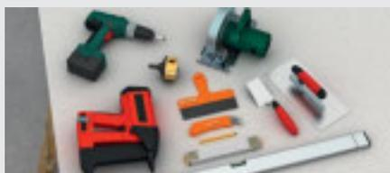
Herramientas para la manipulación de los paneles de fibra yeso **fermacell**
