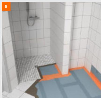
8 En los elementos de desagüe Powerpanel TE son necesarias las bandas de sellado en las juntas con los elementos continuos
