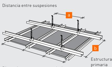
Distancia estructura secundaria para fijación paneles < 500 mm
