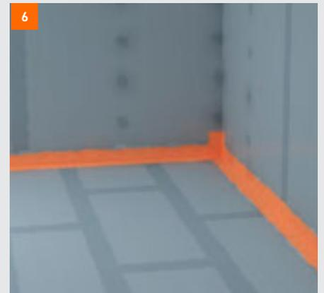
6 Solera seca Powerpanel TE en zona A0: solamente requiere el sistema de impermeabilización en los bordes
