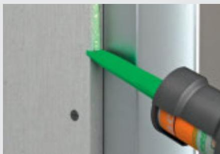
Aplicación precisa del pegamento gracias a la punta-guía especial del cartucho. La punta-guía está diseñada para paneles de 10-12,5 mm de espesor. Para paneles de 15-18 mm de espesor se requiere recortar la punta.
