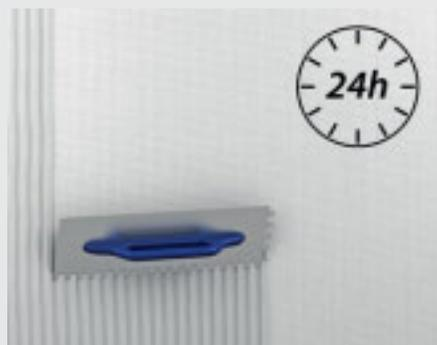
Aplicación de la capa de acabado de mortero ligero fermacell HD de 2-3 mm de espesor después del secado de la capa base
