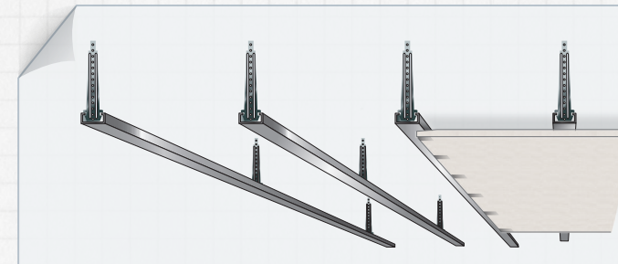
1 Instalación y modulación habitual de perfiles La estructura se coloca de forma tradicional con especial atención en la nivelación de los perfiles.
